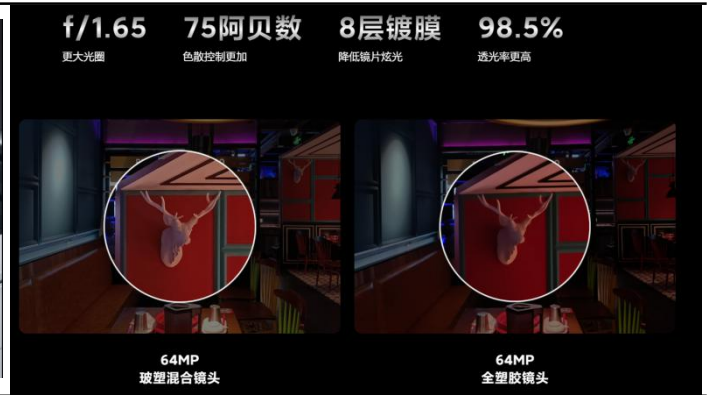
图 7: WLG 镜头与全塑料镜头成像对比图
